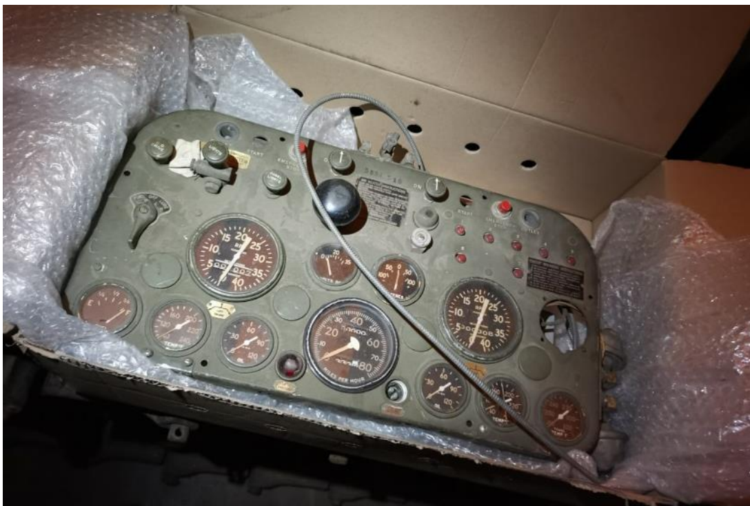
13.attēls. "Sherman" tanka vadības panelis, militāri vēsturisks priekšmets. (2019. gads, robežšķērsošanas vieta, Latvija). Gamma dozas jaudas līmenis uz virsmas līdz 30 \mu\text{Sv/h} , identificēts radionuklīds Ra-226. Virsmas radioaktīvā nosmērētība netika konstatēta.
