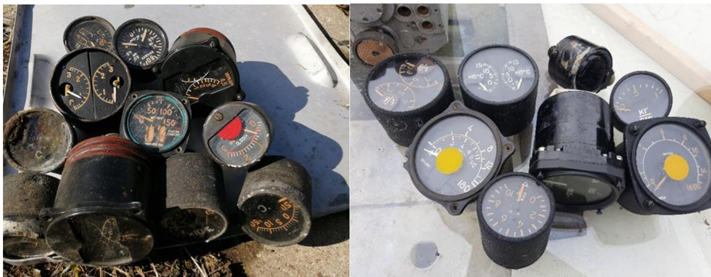
16.,17.attēls. Aviācijas mērinstrumenti (2021. gads, Rīga), identificēts radionuklīds Ra-226. Uz virsmas tika konstatēta alfa ( \alpha ) daļiņu nosmērētība.
