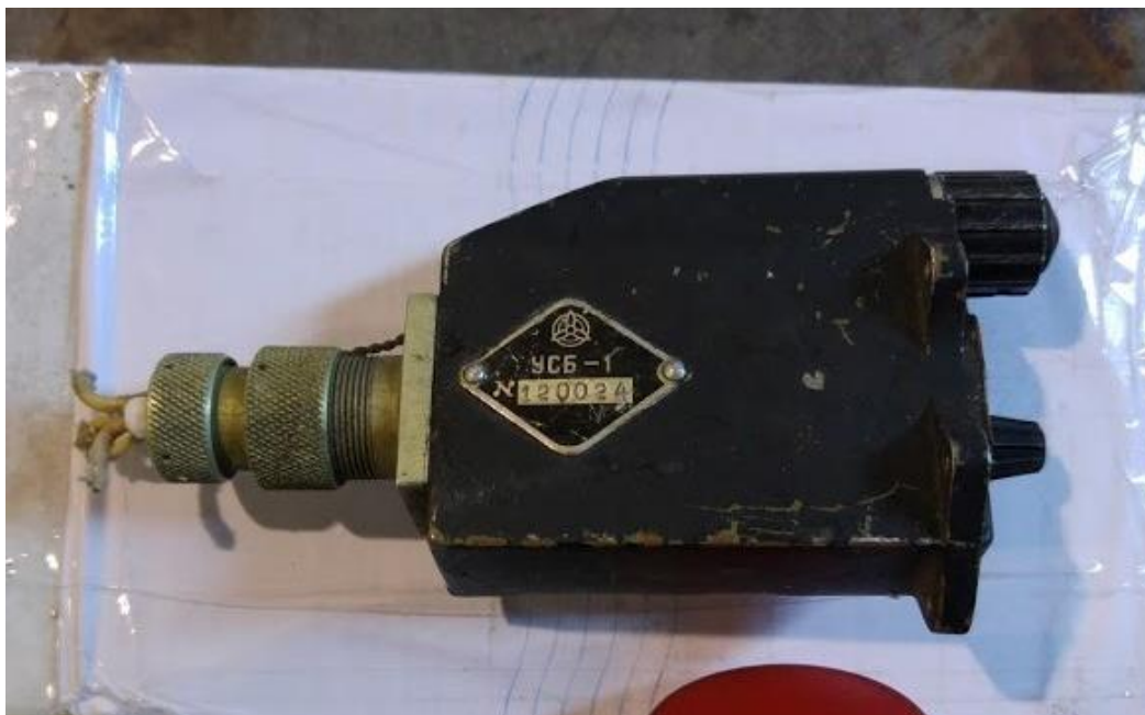
14.attēls. Militārā helikoptera tehniskā ierīce USB-1, atlikušo patronu skaitītājs (2016. gads, robežšķērsošanas vieta, Latvija). Gamma dozas jauda uz virsmas līdz 11,5 \mu\text{Sv/h} , identificēts radionuklīds Ra-226. Virsmas radioaktīvā nosmērētība netika konstatēta.
