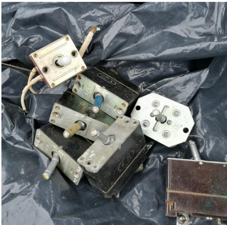
15.attēls. Slēdži, tumbleri ar radioluminiscējošu pārklājumu uz sviras gala (2021. gads, Rīga), identificēts radionuklīds Ra-226. Uz virsmas tika konstatēta alfa ( \alpha ) daļiņu nosmērētība.
