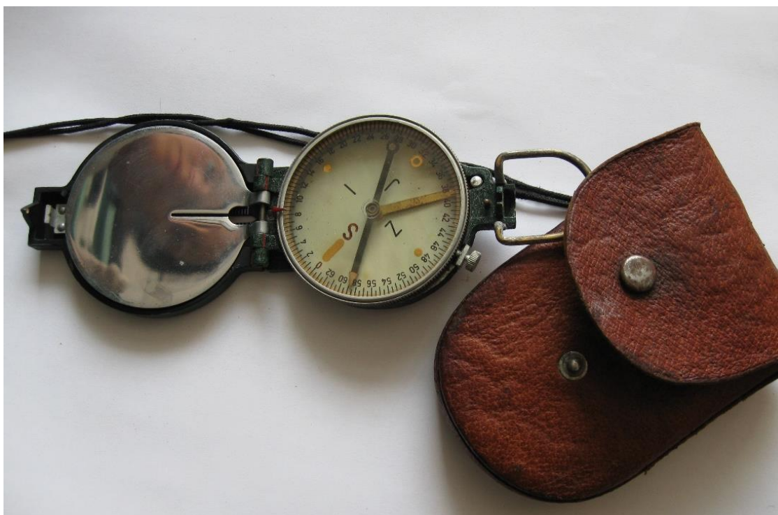
9.attēls. Kompass (2011. gads, robežšķērsošanas vieta Latvijā). Gamma starojuma dozas jaudas līmenis uz kompassa virsmas līdz 6,65 \mu\text{Sv/h} , identificēts radionuklīds Ra-226. Virsmas radioaktīvā nosmērētība netika konstatēta.
