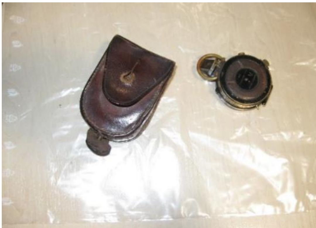
8.attēls. Kompass (2015.gads, robežšķērsošanas vieta Latvijā). Gamma starojuma dozas jaudas līmenis uz virsmas līdz 20,6 \mu\text{Sv/h} , identificēts radionuklīds Ra-226. Virsmas radioaktīvā nosmērētība netika konstatēta.
