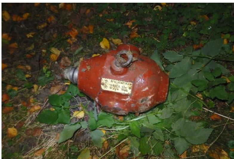
18.attēls. Industriālais līmeņrādis (Cs-137 avots konteinerā) (atrasts 2015. gadā, Rīgā), gamma starojuma dozas jaudas līmenis uz aizsargkonteineru virsmas līdz 3,9 \mu\text{Sv/h} , identificēts radionuklīds Cs-137. Virsmas radioaktīvā nosmērētība netika konstatēta.
