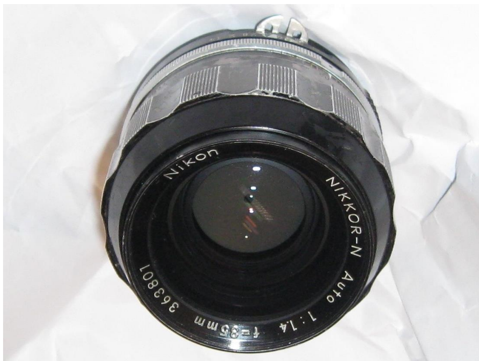
28.attēls. Fotoaparāta objektīvs (2014. gads, robežšķērsošanas punkts, Latvija). Gamma dozas jauda uz virsmas līdz 2,10 \mu\text{Sv/h} , identificēts radionuklīds torijs (Th-232). Virsmas radioaktīvā nosmērētība netika konstatēta.
