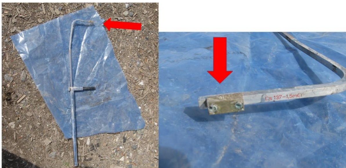
19.attēls. Cēzija avots (2015. gads, Rīga, metāllūžņu pieņemšanas punkts). Gamma dozas jauda uz virsmas līdz 1,8 \text{mSv/h} , identificēts radionuklīds Cs-137. Virsmas radioaktīvā nosmērētība netika konstatēta.
