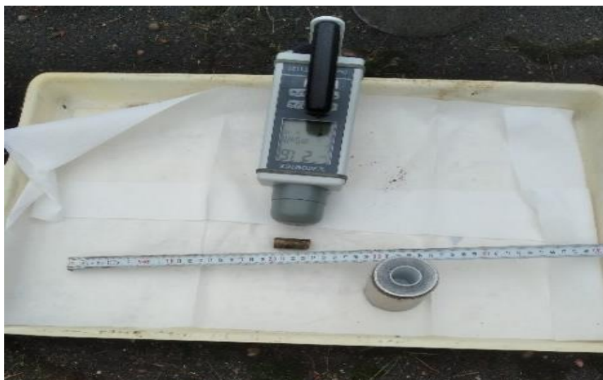
20.attēls. Slēgts cēzija Cs -137 avots (2020. gads, Rīga, metāllūžņu pieņemšanas punkts). Gamma dozas jauda 10 cm attālumā 2,1 mSv/h, identificēts radionuklīds Cs-137). Virsmas radioaktīvā nosmērētība netika konstatēta.
