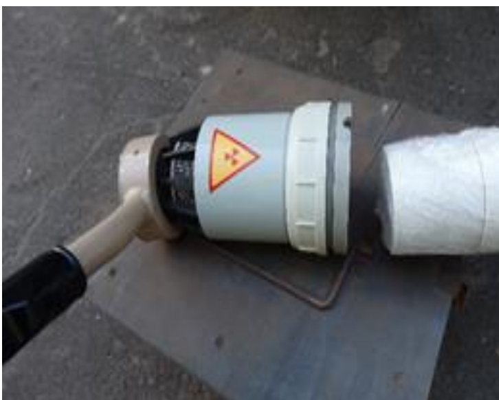
21., 22.attēli. Am-241 saturoši dūmu detektori RID-1 (РІД-1). Gamma dozas jaudas līmenis uz virsmas konstatēts līdz 10,6 \mu Sv/h, identificēts radionuklīds Am-241. Virsmas nosmērētība netika konstatēta.
